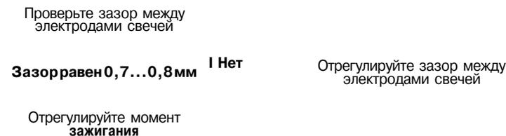
**Рис. 41.** Схема поиска неисправности в бесконтактной системе зажигания, когда двигатель работает неустойчиво на холостом ходу.
