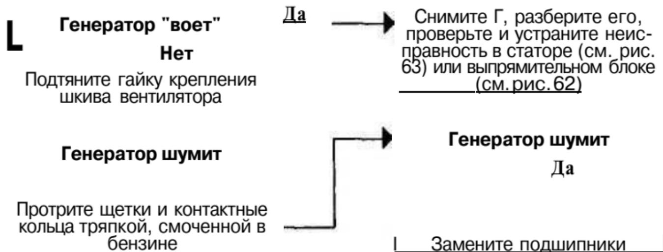
Рис. 74. Схема поиска неисправности, когда генератор издает повышенный шум.
