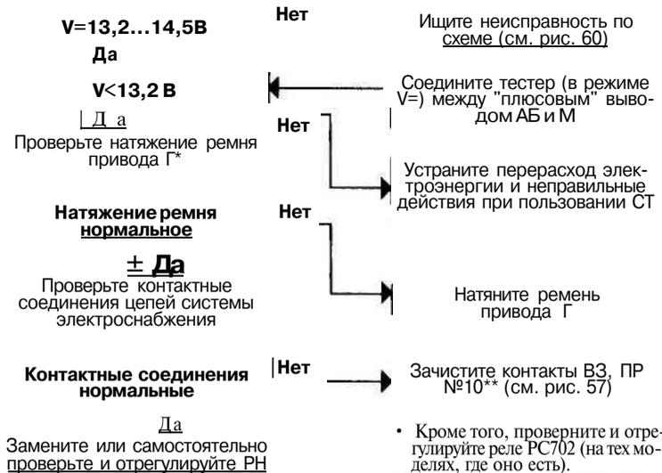
Рис. 71. Схема поиска неисправности, когда батарея разряжается в процессе эксплуатации, но внешних признаков ненормальной работы генератора нет.
